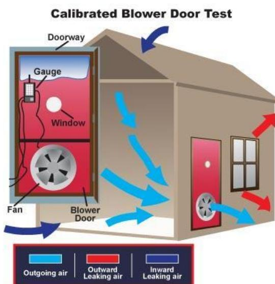
Blower door test A-Wert è una variante del BDT classico e sostanzialmente si effettua per misurare la tenuta all'aria di un
